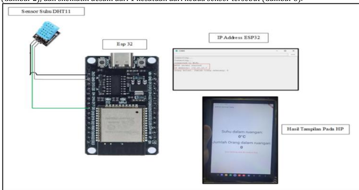
Gambar 1. Desain Skematik Sensor Suhu (DHT11) (Sumber: Dokumentasi pribadi, 2024)
