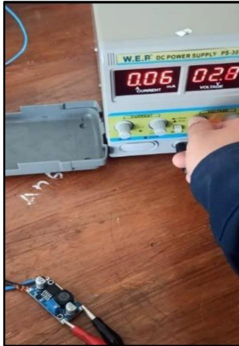
Gambar 6. Melakukan adjust pada boost converter
